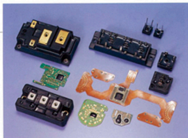
液状エポキシ樹脂製品が使用されている個別半導体製品、COB Various discrete semiconductors and COB, insulated by liquid epoxy product.
